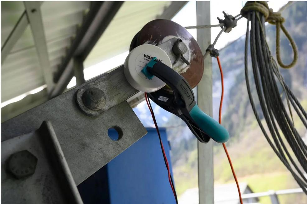
Die Geräusche und Klänge der Rollen, Masten und Seile werden dokumentiert.
